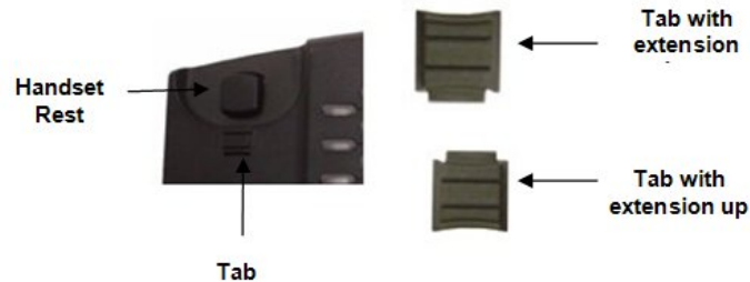
Figure 4: Mise en place de l'onglet pour le montage du téléphone au mur
