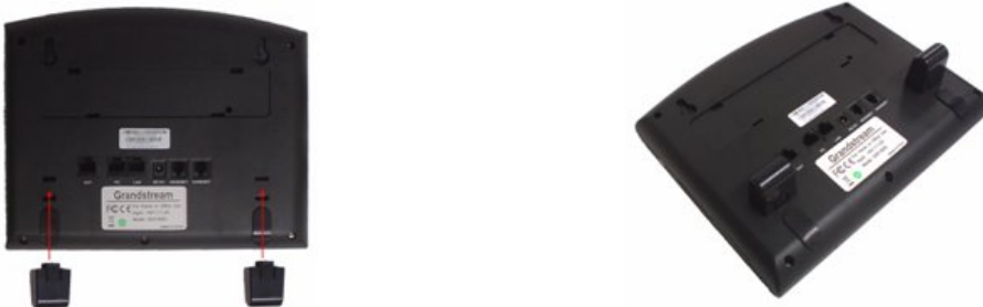
Figure 2: Attachement des supports de montage mural pour le GXP2010
