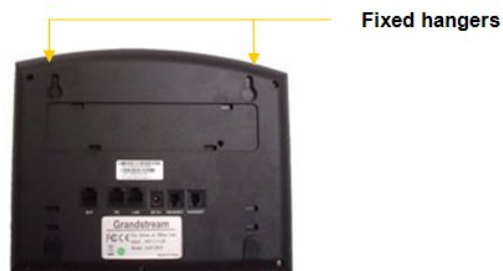
Figure 3: Localisation des cintres de fixation pour le GXP2010
